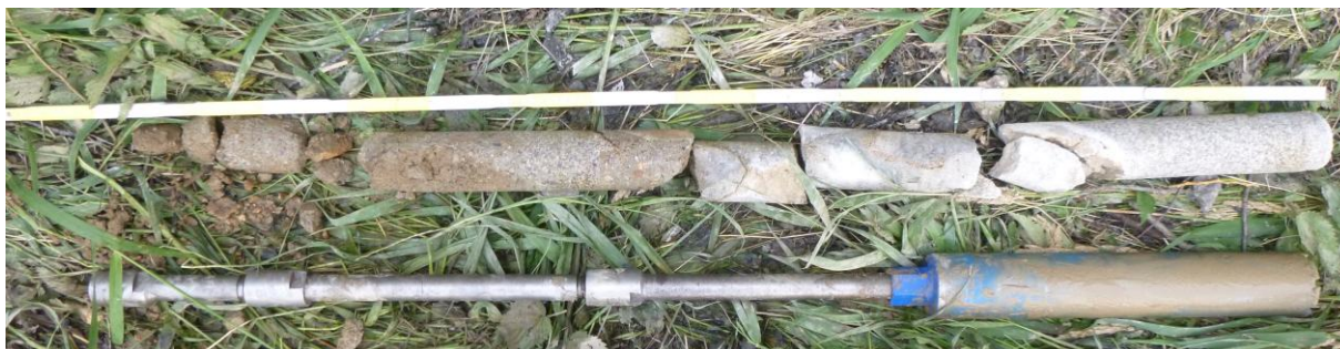
FOTO č.3.4: Dokumentace vrtu VO2 – opěra 2 v levé části
