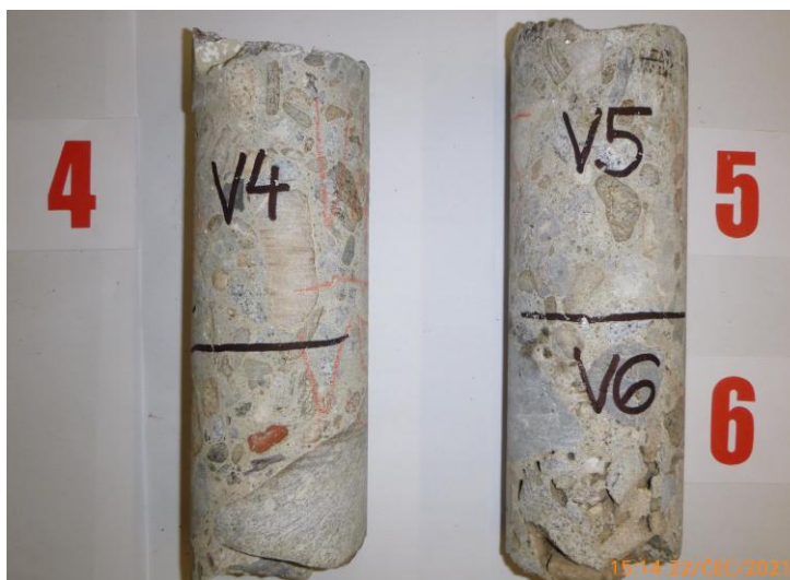
FOTO č.3.1: Dokumentace vývrtů pro destruktivní zkoušky pevnosti v tlaku betonu úložných prahů v levé části mostu
